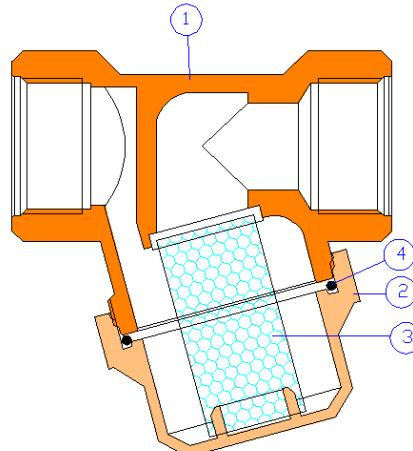
Фильтр состоит из корпуса 1, заглушки 2, фильтроэлемента 3 и уплотнительного кольца 4. Корпус и заглушка фильтра выполнены из латуни марки CW617N (ЛС59-2) с гальванопокрытием из никеля.
